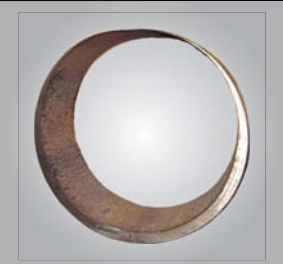
Corrosão e Erosão
