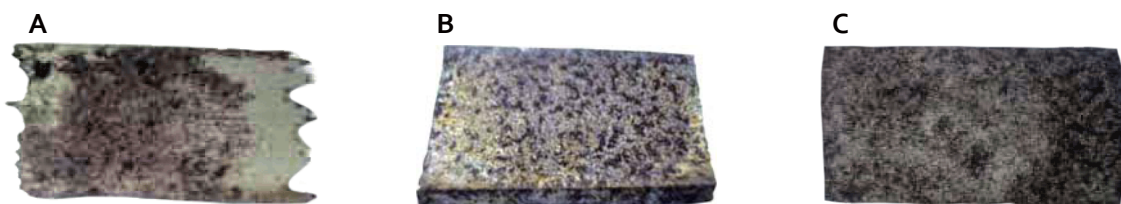
FIGURA 8: (A) corpo-de-prova imerso em H 2 SO 4 0,5 mol.dm -3 , (B) corpo-de-prova imerso em NaCl 3%, (C) corpo-de-prova imerso em HCl 0,5 mol.dm -3 . As amostras possuíam as dimensões de 25x15x2mm.
