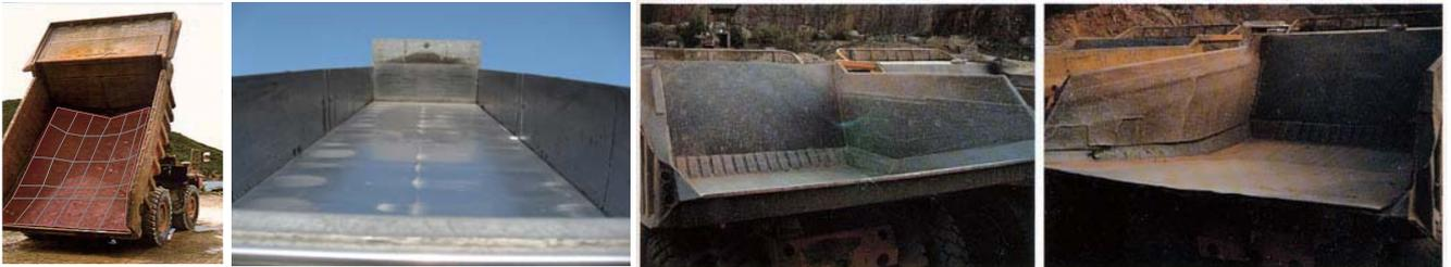
■ 鉱山等で使用されている大型ダンプトラックの荷台部にセラミック粒入りライナーを設置する事で、騒音、衝撃等を吸収し、荷台への損傷も減ります。ライナーは簡単に取替えも出来ます。
