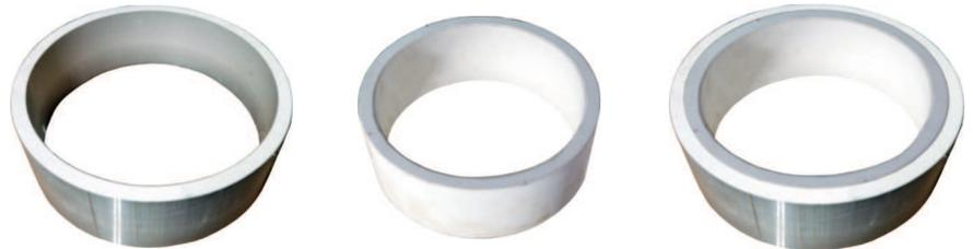
(上) 写真左から、鋼管、セラミックリング、鋼管に入れたセラミック
