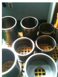
加圧成型セラミックリングの製造には、様々な技術が必要です。ただのリングだと思われそうですが、高温焼成すると、形が変形してしまう為に、独自の技術が必要になり、プレスも超大型プレスで圧力を掛けなければ硬度なセラミックリングにはなりません。
